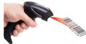
Hình 5. Thiết bị quét mã vạch trên vé tàu xe, hàng hoá
