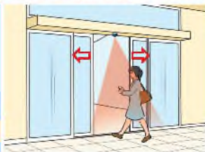
Hình 3. Cửa có gắn cảm biến tự động đóng, mở
