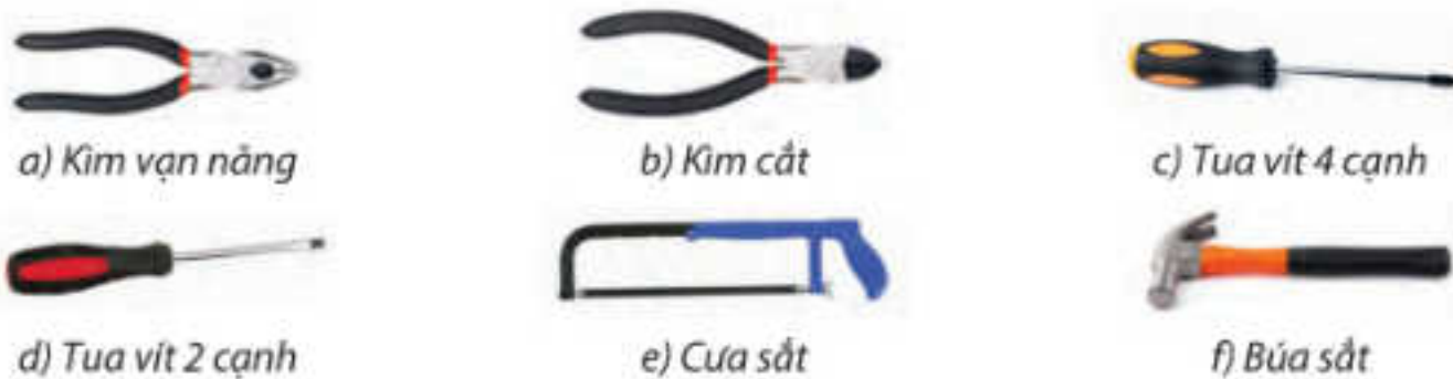
Hình 4.5. Một số dụng cụ cầm tay sử dụng trong lắp đặt mạng điện trong nhà
