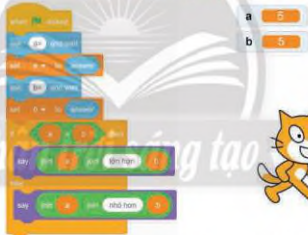
Hình 2. Chương trình đưa ra kết quả sai khi giá trị a, b bằng nhau
