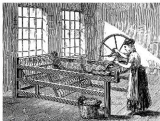
2.2 Máy kéo sợi Giեն-ni 16 – 18 cọc suốt
