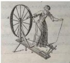
2.1 Kéo sợi bằng tay dùng 1 cọc suốt
