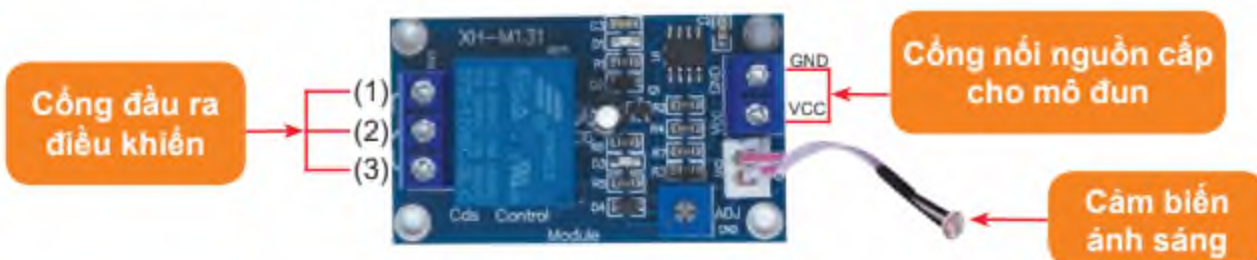
Hình 16.4. Mô đun cảm biến ánh sáng XH M131
