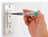
Hình 8.7. Cách sử dụng bút thử điện
