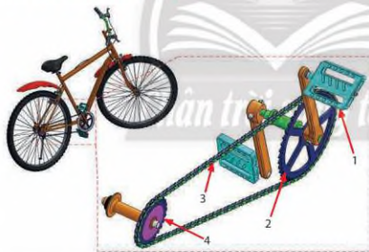
Hình 6.2. Truyền chuyển động trên xe đạp (1) Bàn đạp; (2) Đĩa xích; (3) Dây xích; (4) Líp
