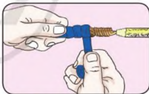
Hình 10.5. Bọc dây cách điện
