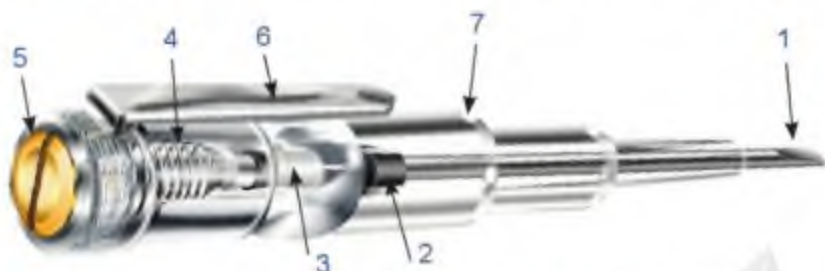
Hình 11.3. Cấu tạo bút thử điện 1. Đầu bút thử điện; 2. Điện trở; 3. Đèn báo; 4. Lò xo; 5. Nắp bút; 6. Kẹp kim loại; 7. Thân bút.
