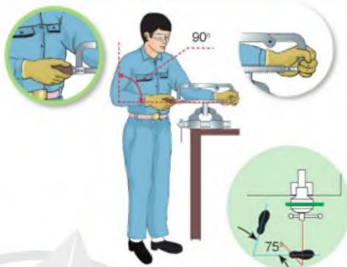
Hình 7.3. Cách cầm cửa và tư thế đứng cửa
