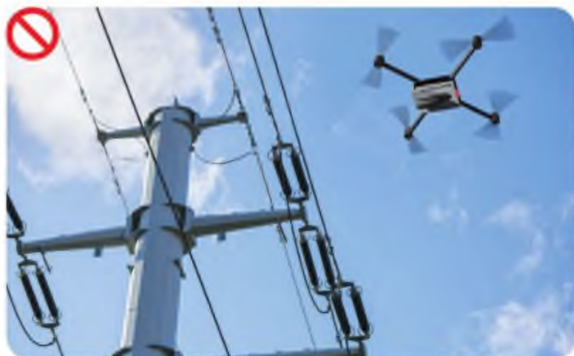
Hình 10.3. Vi phạm hành lang an toàn lưới điện cao áp
