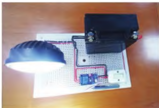
b) Đèn LED sáng khi phòng tối (che ánh sáng ở đầu cảm biến)
