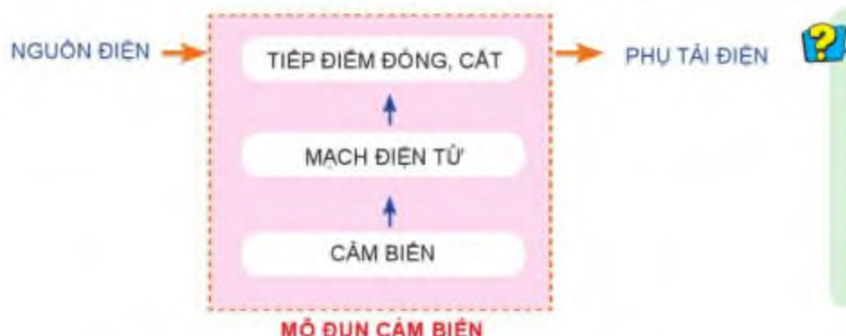
Hình 13.4. Sơ đồ khối mạch điện điều khiển sử dụng mô đun cảm biến
