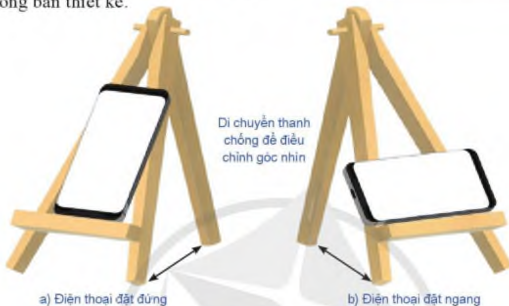
Hình 17.6. Thử nghiệm giá đỡ điện thoại mẫu
