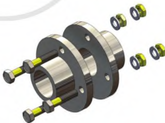
Hình 4.2. Các chi tiết của đầu nối ống
