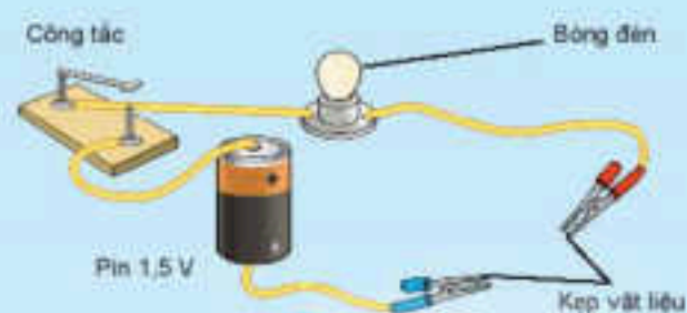
Hình 12.3 Thí nghiệm xác định khả năng dẫn điện của vật liệu
