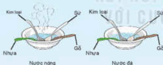
Hình 12.4 Thí nghiệm xác định khả năng dẫn nhiệt của vật liệu
