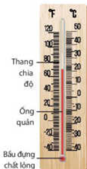
▲ Hình 7.2. Cấu tạo của nhiệt kế
