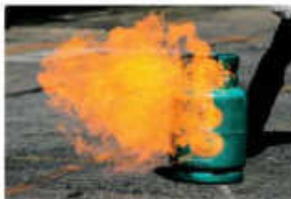
▲ Hình 12.2. Rò rỉ gas gây cháy nổ
