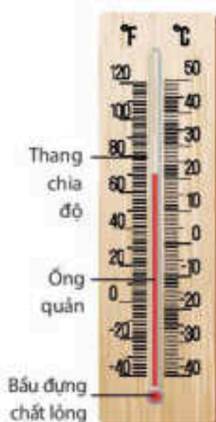
▲ Hình 7.2. Cấu tạo của nhiệt kế
