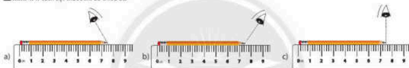
▲ Hình 4.5. Cách đặt mắt khi đo chiều dài
