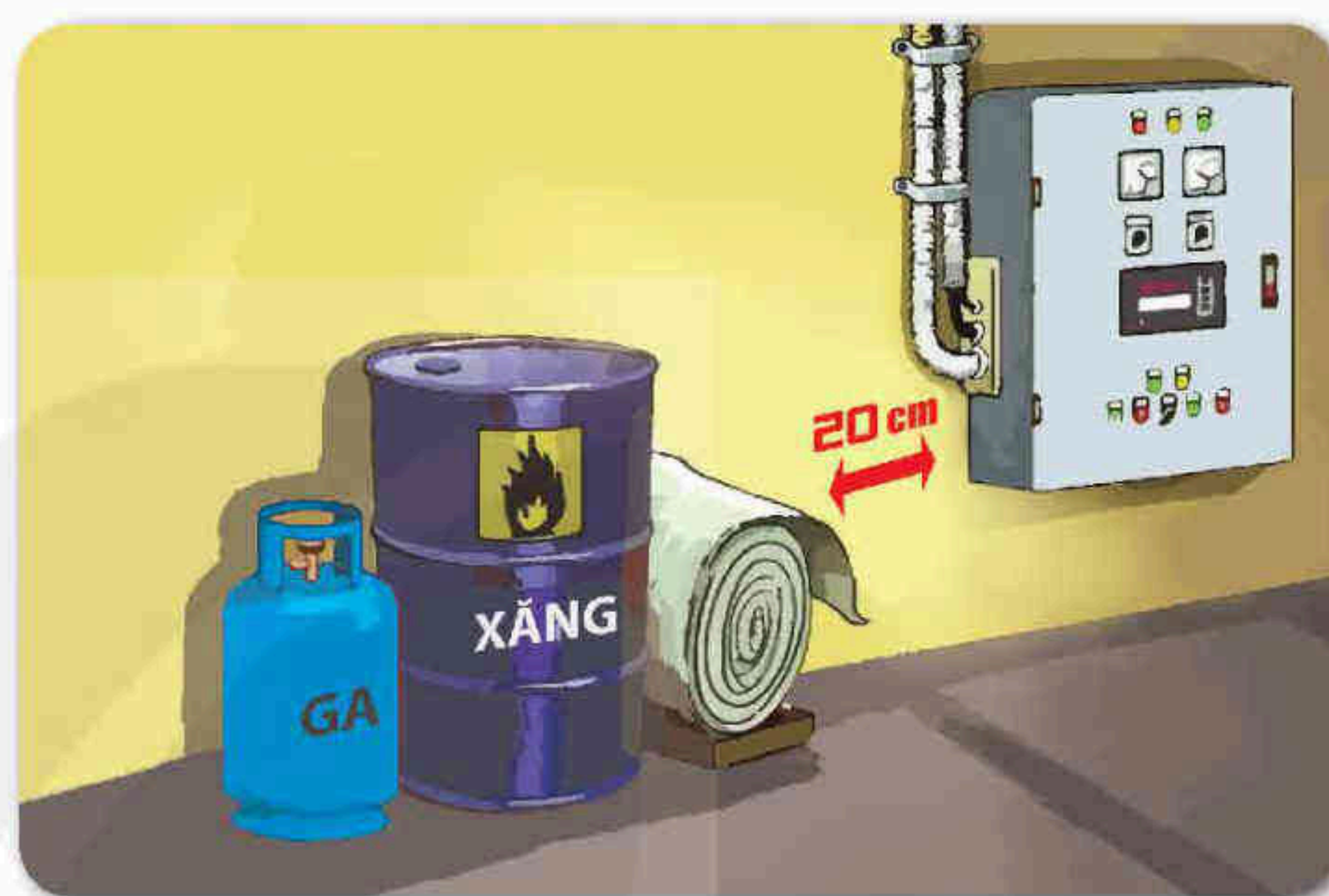
b) Chất đốt để gần tủ điện
