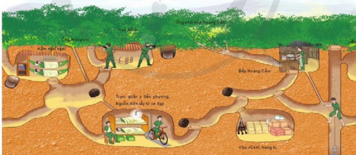
Hình 2. Lát cắt mô phỏng một đoạn của hệ thống đường hầm trong Địa đạo Củ Chi
