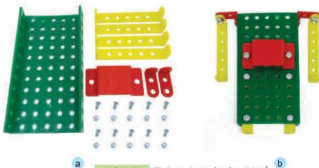
Hình 3 Thân robot và các chi tiết
