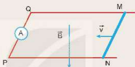
Hình 16.9. Mô tả thí nghiệm thanh kim loại trượt trên hai đoạn dây dẫn
