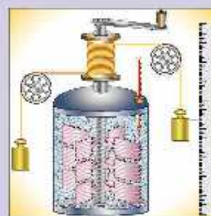
▲ Hình 3.7. Mô hình thí nghiệm xác định mối liên hệ giữa hai đơn vị cal và J
