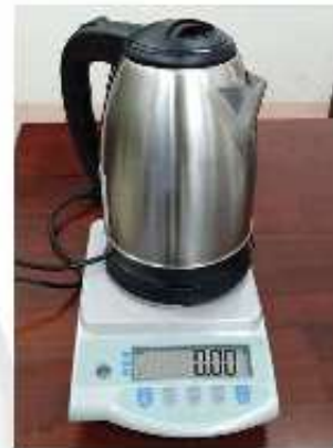
▲ Hình 4.3. Bố trí thí nghiệm đo nhiệt hoá hơi riêng của nước
