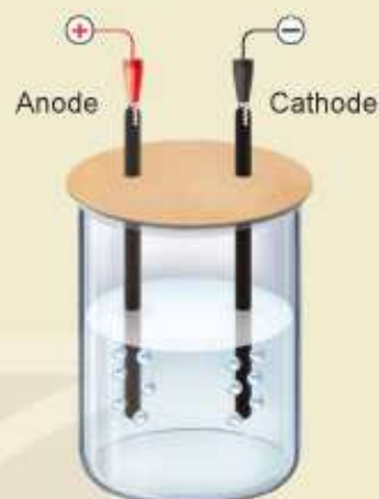
Hình 16.3. Sơ đồ thí nghiệm điện phân dung dịch NaCl với điện cực trơ
