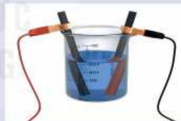
Hình 20.2. Điện phân dung dịch \text{CuSO}_4 với hai điện cực than chì
