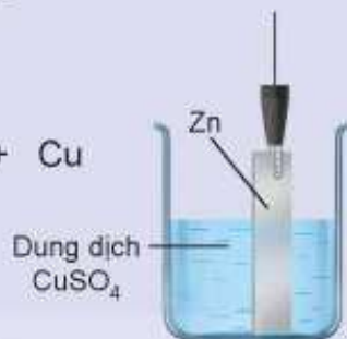
Hình 15.6. Nhúng thanh Zn vào dung dịch \text{CuSO}_4
