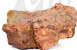
Quặng bauxite (Thành phần chính: \text{Al}_2\text{O}_3 )
