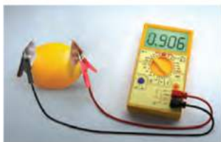
▲ Hình 12.6. Sơ đồ pin chanh
