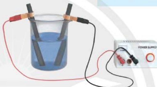
▲ Hình 13.1. Điện phân dung dịch CuSO_4 , điện cực graphite
