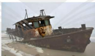
(b) Vỏ tàu biển bị gỉ
