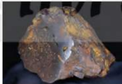
Quặng hematite (Thành phần chính: \text{Fe}_2\text{O}_3 )
