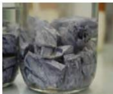
▲ Hình 17.3. Sodium được ngâm trong dầu hoả
