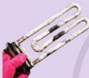
Hình ảnh bộ phận làm nóng của máy giặt sau khi tiếp xúc với nước cứng trong một thời gian dài
