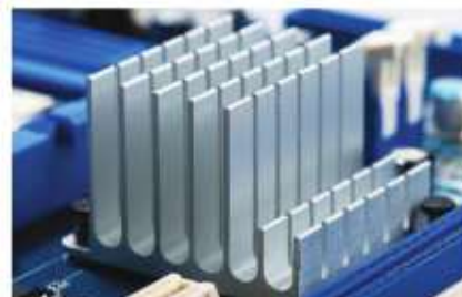
b) Các thanh nhôm dùng làm thanh tản nhiệt trong các thiết bị
