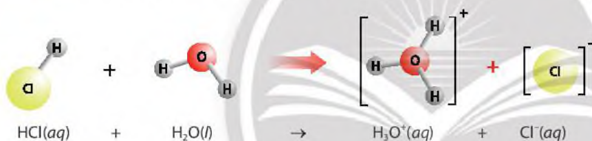
▲ Hình 2.4. Sơ đồ minh hoạ quá trình tương tác của \text{HCl} và nước trong dung dịch
