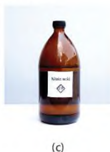
▲ Hình 5.4. Cấu tạo phân tử nitric acid (a), mô hình phân tử nitric acid (b), nitric acid được bảo quản trong lọ thủy tinh tối màu (c)
