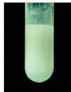
▲ Hình 7.6. Phản ứng của dung dịch \text{BaCl}_2 với dung dịch \text{Na}_2\text{SO}_4
