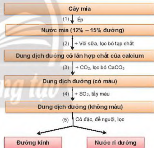
▲ Các công đoạn chính trong quy trình sản xuất đường kính từ cây mía
