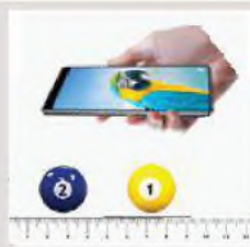
Hình 30.4. Thiết kế thí nghiệm xác định động lượng của hai viên bi trước và sau va chạm
