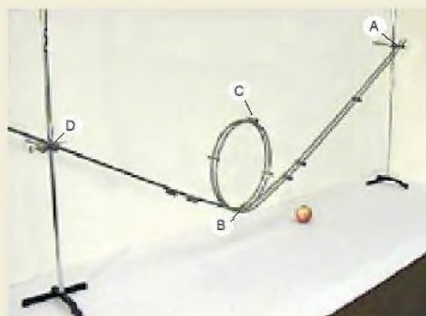
Hình 26.6. Mô hình minh họa định luật bảo toàn năng lượng
