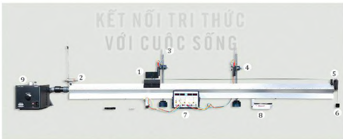
Hình 15.2. Thí nghiệm minh họa định luật 2 Newton
