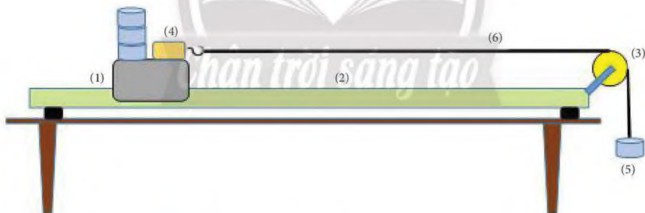
▲ Hình 10.8. Sơ đồ bố trí thí nghiệm khảo sát định luật II Newton
