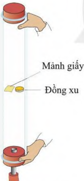
Hình 2.5. Thí nghiệm vật rơi trong ống được hút khí
