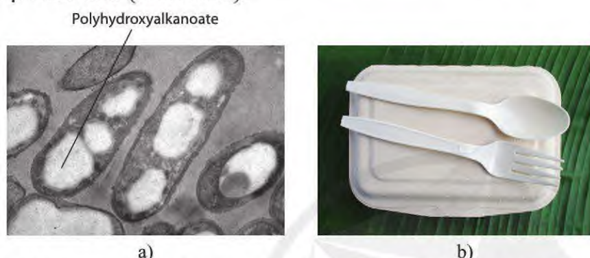
Hình 19.2. Polyhydroxyalkanoate tích lũy trong tế bào vi khuẩn (a) và sản phẩm dùng một lần làm từ các hạt polyhydroxyalkanoate (b)
