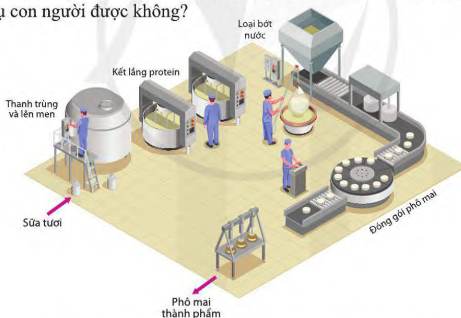
Hình 20.1. Mô hình các công đoạn sản xuất phô mai trong nhà máy
