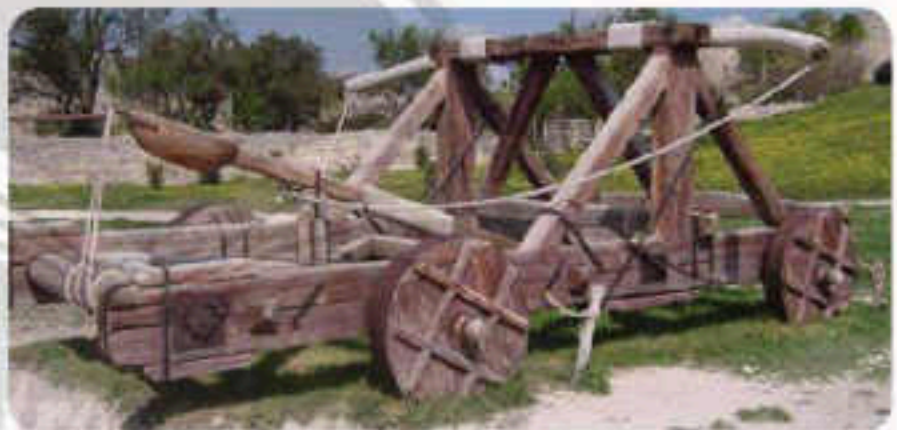
Hình 9.15. Mô hình máy bắn đá của người Hy Lạp cổ
