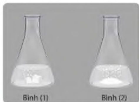
Hình 16.6. Minh họa thí nghiệm nghiên cứu ảnh hưởng của bề mặt tiếp xúc đến tốc độ phản ứng
