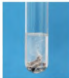
▲ Hình 12.3. Kim loại Zn phản ứng với dung dịch \text{H}_2\text{SO}_4 loãng
