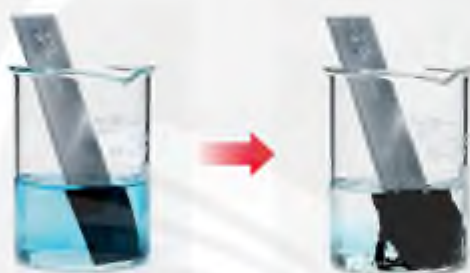
▲ Hình 12.4. Kim loại Zn phản ứng với dung dịch \text{CuSO}_4
