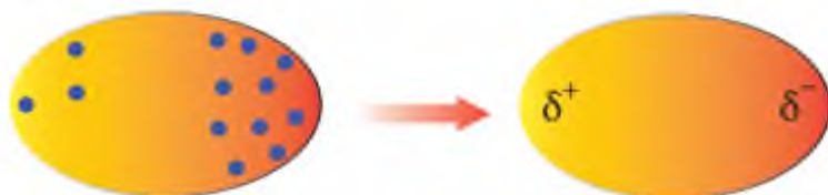
▲ Hình 11.7. Lượng cực tạm thời được hình thành do sự phân bố không đồng đều của các electron trong phân tử
